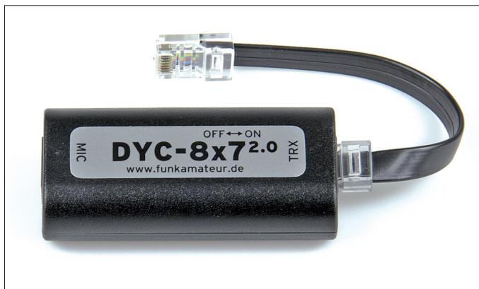
Bild 1: Dynamikkompressor im fertig aufgebauten und einsatzbereiten Zustand
